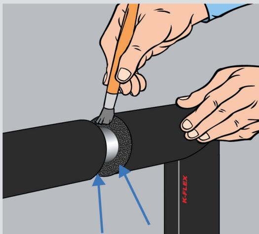
В случае, если участки изоляции, подходящие к углу, уже окончательно смонтированы, длина угловой секции должна быть точно вымерена с учетом наибольших припусков (2 мм)
