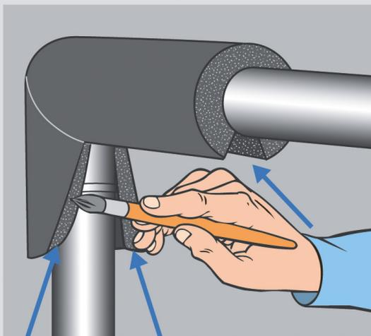
**5** Оденьте угол на изгиб трубы и нанесите клей на оба края разреза.
