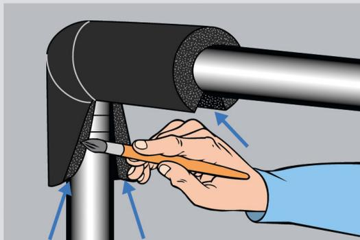
10 Тщательно приклейте края угла к трубе и к остальной изоляции.
