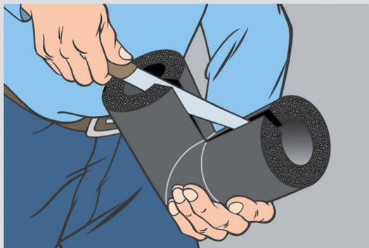
9 Наденьте угол на изгиб трубы и нанесите клей на оба края разреза. Дайте клею подсохнуть, затем соедините края и сильно сожмите на очень короткое время.
