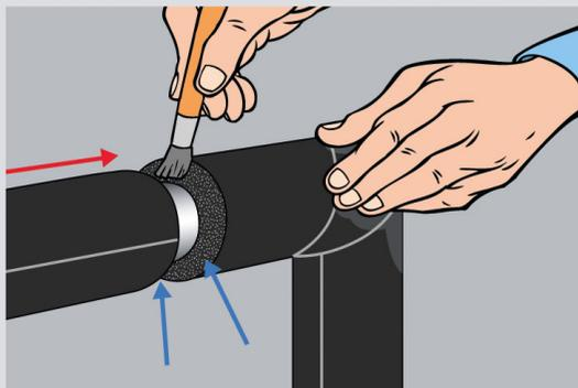
11 В случае, если участки изоляции, подходящие к углу, уже окончательно смонтированы, длина угловой секции должна быть точно измерена с учетом небольших припусков (2 мм).
