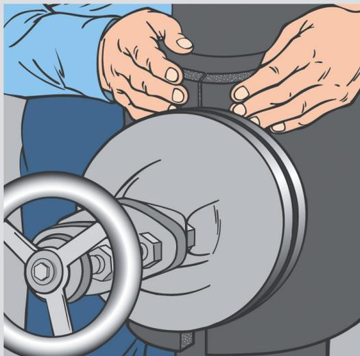
Измерьте диаметр торцевых фланцев и определите форму и размер пластины, через которую должно устанавливаться изоляционное кольцо.
