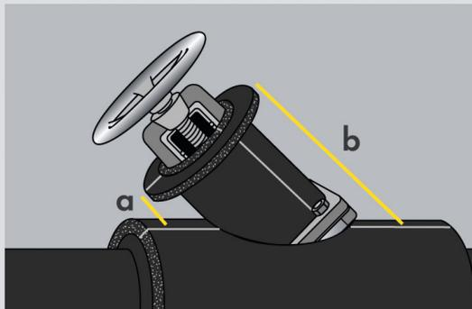
Измерьте длину окружности изоляционного кольца с помощью полоски "K-FLEX" той же толщины. Перенесите полученное измерение на листовую материал и отложите от его концов перпендикулярные отрезки длиной b, от его середины отрезок длиной a. Проведите с помощью циркуля дуги окружностей, как показано на чертеже, при этом окружность, расположенная в центре, имеет радиус равный четверти диаметра изолированного вентиля. (см.рисунок 6)
