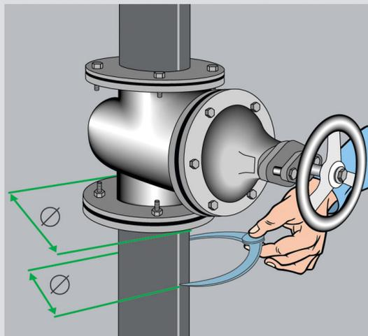
По результатам измерений вычислите радиусы изоляционных колец. Прочертите с помощью циркуля внешнюю и внутреннюю окружности колец на двух различных кусках материала "K-FLEX" соответствующей толщины.
