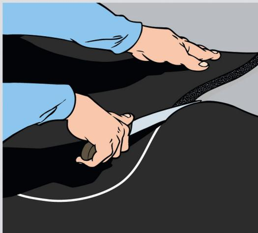
Скосите кромки выпуклых участков кривой линии по направлению к внутренней поверхности изоляции "K-FLEX". **24**
