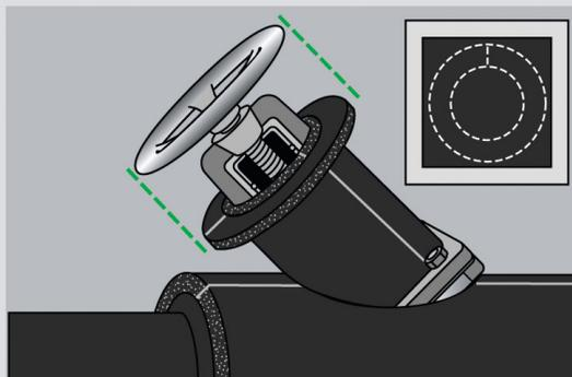
Измерьте расстояния (а и b) от изоляции фланцев вентиля до вырезанного кольца с учетом его толщины.
