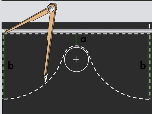
Проведите плавную кривую линию, соединяющую все дуги, как показано на чертеже. Аккуратно отрежьте материал по окончательной кривой.
